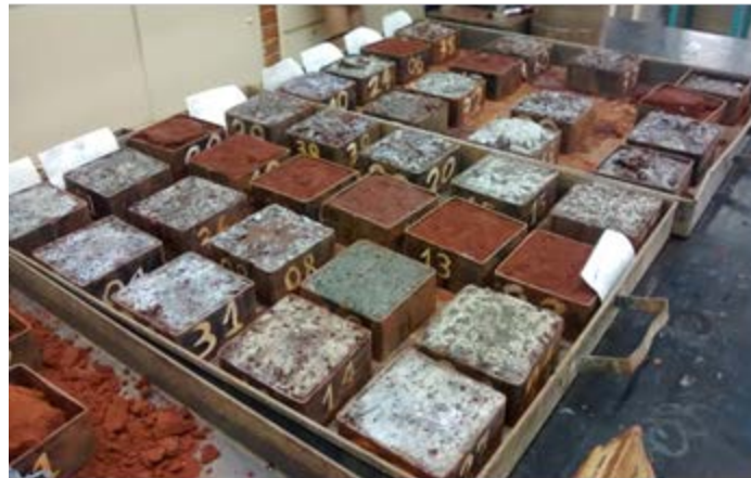
Figura 3: Corpos de prova (CP) de amostras indeformadas de solo com e sem aplicação de vinhaça.
