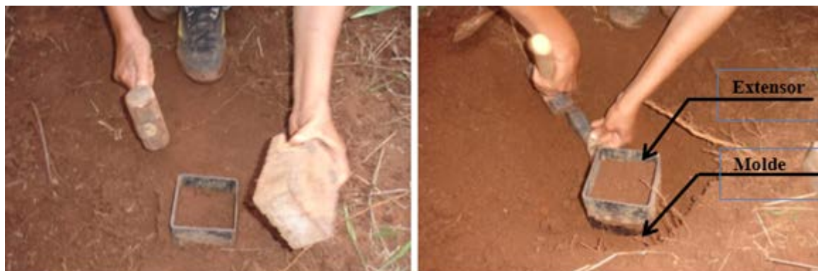
Figura 2: Trabalho de campo -retirada de amostras indeformadas para ensaio de Inderbitzen.
